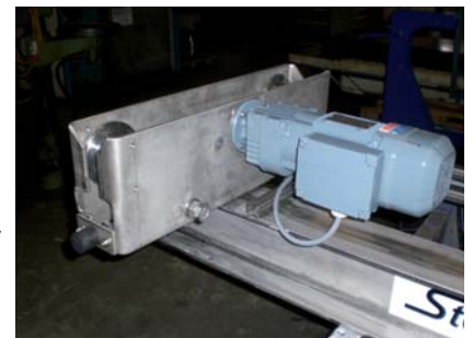
Bild links: Laufräder am Kopfträger aus säurebeständigem Kunststoff für beste Laufeigenschaften und geräuschreduzierten Betrieb.
