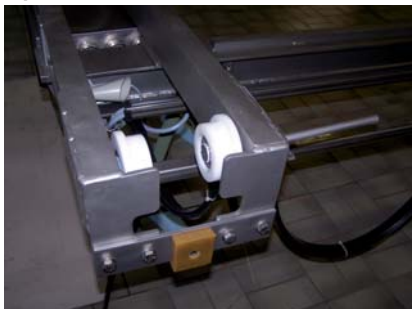
Bild links: Laufräder am Kopfträger aus säurebeständigem Kunststoff für beste Laufeigenschaften und geräuschreduzierten Betrieb.
